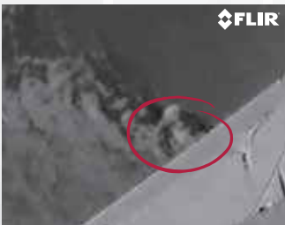
Imagem de um vazamento de gás de uma unidade de produção.
