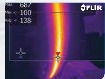
Controle de posicionamento de tubos em um soldador automatizado.
