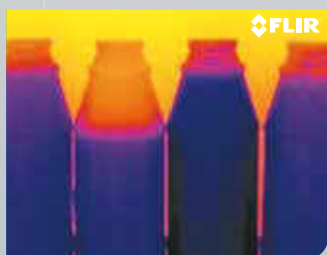
A imagem permite verificar se houve falta ou excesso de preenchimento.
